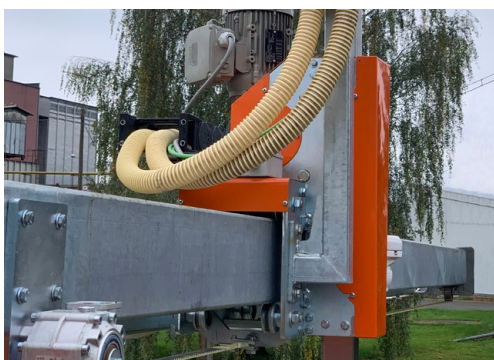
Čtvercová dvouplášťová sonda s bočním uchycením na rameni pro jednodušší servisovatelnost
